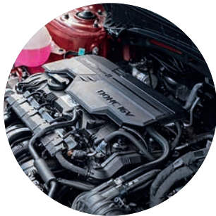
ТУРБОДИЗЕЛЬ SMARTSTREAM D2.0 РАЗВИВАЕТ 186 Л. С. ПРИ 4000 ОБ/МИН И МАКСИМАЛЬНЫЙ КРУТЯЩИЙ МОМЕНТ 416 НМ В ДИАПАЗОНЕ 2000–2750 ОБ/МИН
