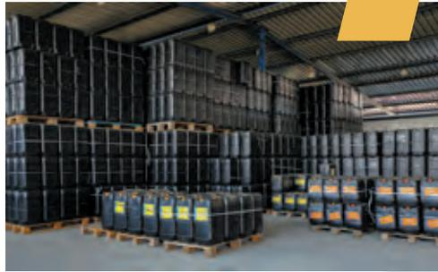
В населенные пункты, где нет автоматизированных заправок станций (АЗС), топливо доставляется в специально разработанной для этого пластиковой канистре с добавлением антистатического компаунда, которая дает возможность обеспечить безопасный розлив в тару взрывоопасных нефтепродуктов. Тара изготавливается на Якутской нефтебазе.
