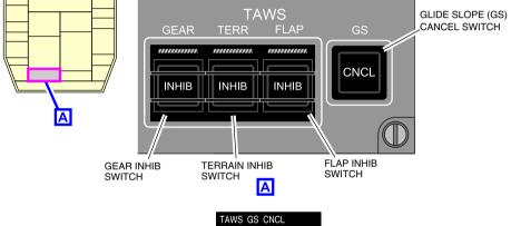
TAWS FLAP INHIB TAWS GEAR INHIB TAWS TERR INHIB
